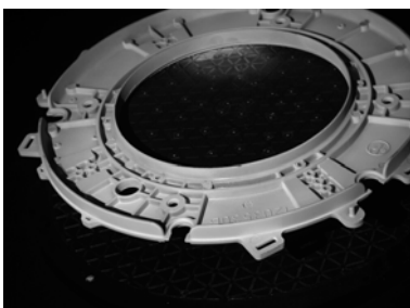
Mit Scanspray behandeltes Messobjekt
